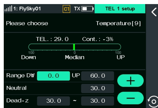
Die Einstellungs-Schnittstelle der Telemetrie-Steuerung
