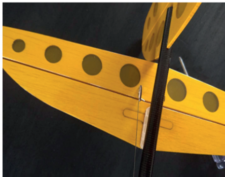
Einhängen des Höhenruder Seilzuges
