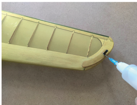
Einkleben des Bolzens mit Sekundenkleber
