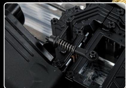
ABS Bremsgestänge lässt sich optimal anpassen
