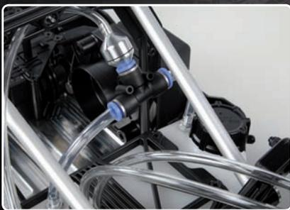
Vapro Tankentlüftungssystem für ein perfektes Arbeiten des Vergasers
