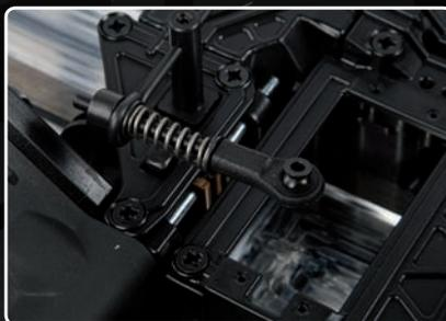
ABS Bremsgestänge lässt sich optimal anpassen
