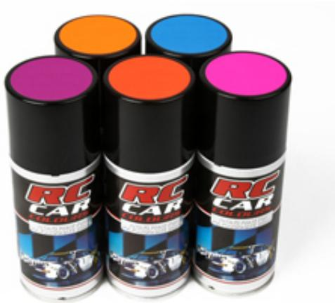
5 Nuovi colori "Fluorescenti": Bomboletta da 150ml di colore spray fluorescente per policarbonato e Lexan, per scocche trasparenti di automodelli. La vernice apposta per Lexan è elastica, si spruzza dall'interno e non si stacca in caso di urti grazie alle sue doti di elasticità. Sgrassare la superficie da verniciare prima dell'uso con sapone neutro. Questi colori raggiungono la loro tonalità ed effetto definitivi dopo aver dato un color BIANCO (RCC710) come ultima mano.
