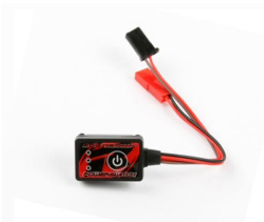
Der Powerswitch wurde als Ersatz für den mechanischen Schalter der Empfängerstromversorgung in Verbrennerfahrzeugen entwickelt.
