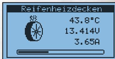
An den Overloader 2 können auch Reifenheizdecken angeschlossen werden. Die Temperatur kann von 45-75°C eingestellt werden.
