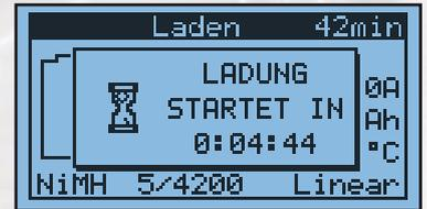
Der Overloader 2 verfügt über eine Timerfunktion. Hierbei wird die Zeit eingegeben wann der Ladevorgang beginnen soll.
