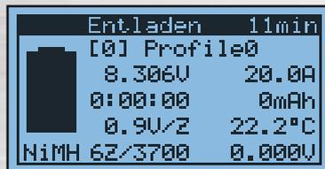
Mit bis zu 20 Ampere Entladestrom gehört der Overloader zu den schnellsten Lade-/Entladegeräten. Die grafische Entladekurve gibt Aufschluß über den Zustand des Akkus.
