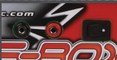
**Starthilfe:** Mit wenigen Handgriffen kann die Startbox umgebaut werden damit man sie direkt von außen mit 12V betreiben kann
