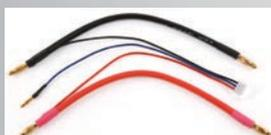
Um optimale Ergebnisse beim Laden zu erzielen lassen Sie Ihren wertvollen LiPo Akku von einem Balancer überwachen. Unser Ladekabel ist ausgerüstet mit 4mm Goldkontakt Steckern an Akku- und Ladegeräteseite und 2mm Goldkontakt für den Mittenabgriff für niedrigsten Übergangswiderstand. Ausgerüstet mit EH-Balanceranschluss. Hochflexible 3,5mm<sup>2</sup> Silikonkabel mit 14cm Länge.
