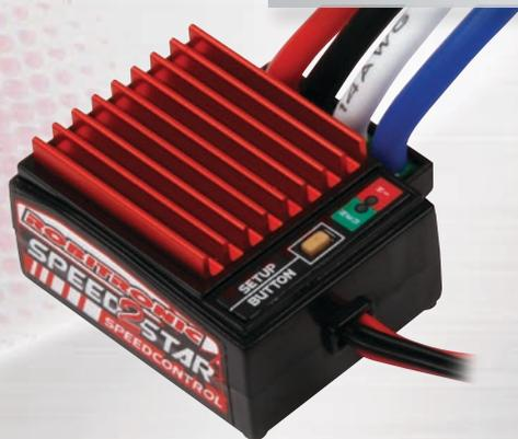
Um den Anforderungen im Crawler und Trial Sport gerecht zu werden ist der Speed Star 2 Crawler mit entsprechender Hard- und Software ausgerüstet worden. So wird ein verzögerungsfreies Umschalten von Vorwärts nach Rückwärts und entsprechendes feinfühliges Regeln erreicht. Die „Active Hill Brake“-Funktion bremst den Crawler auch auf größter Steigung zuverlässig.
