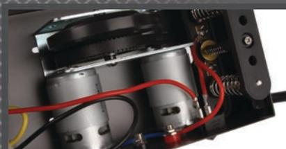
**Gleich zwei 550er Motore** sorgen für die nötige Power der Starter Box
