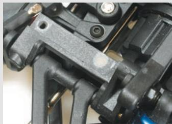
Das Füllmaterial in die betreffende Stelle geben und mit Sekundenkleber härten. Das Material wird extrem fest und ein neues Gewinde kann hineingeschnitten werden.
