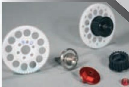
Hauptzahnradaufnahme mit Zentralmutter, absolut präziser Rundlauf des Zahnrades, großes Riemenrad verhindert, dass der Riemen überspringt.
