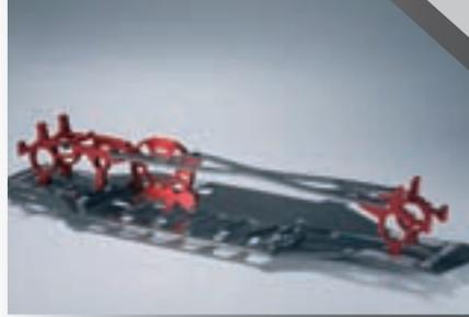
Absolut tweakfreies Chassis durch einteilige stabile Alu-Seitenteile, die sich durch Snap-in-Funktion selbst zentrieren.
