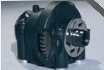
Mitteldifferential mit Stahlhauptzahnrad komplett gekapselt, verhindert Defekte durch Steine, etc.
