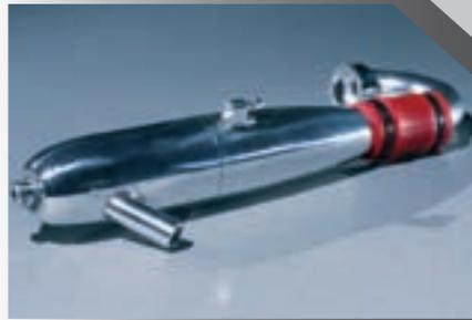
Poliertes Alu-Resorrohr, um noch mehr Leistung aus dem Axial 28er zu holen.
