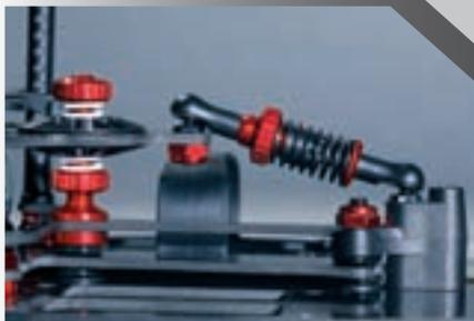
Kompakter Aufbau der Reibungsdämpfereinheit und des Stoßdämpfers.
