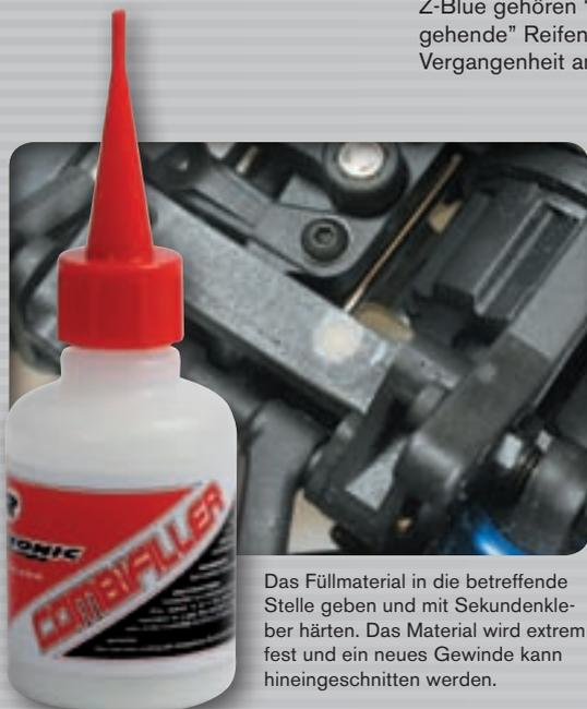
Das Füllmaterial in die betreffende Stelle geben und mit Sekundenkleber härten. Das Material wird extrem fest und ein neues Gewinde kann hineingeschnitten werden.
