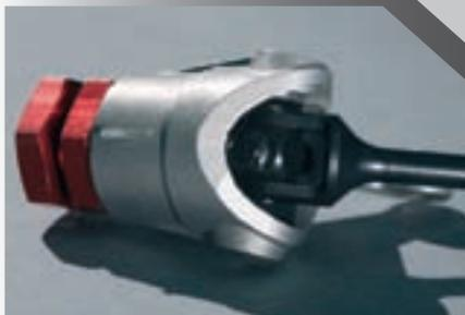
Kardantriebswellen an der Vorderachse sorgen für besseres Kurvenverhalten und weniger Verschleiß.
