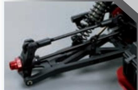
... extra lange Querlenker auf der Hinterachse sorgen für eine optimale Straßenlage im harten Gelände.
