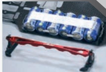
Freie Wahl der Akkubefestigung je nach Geschmack mit Gewebeband oder Haltebügel, aber immer ohne das Chassis zu verspannen.
