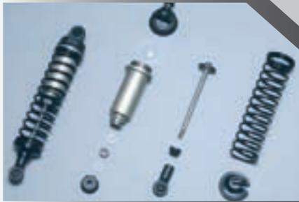
Großvolumige Aluminium-Stoßdämpfer mit 3,5 mm extra starken Kolbenstangen.
