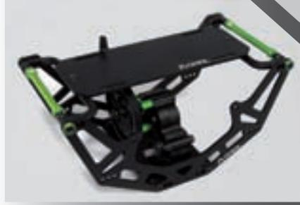
Das Mittelgetriebe sorgt für eine optimale Balance zwischen der vorderen und hinteren Achse.
