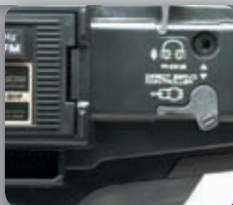
Anschlüsse für Kopfhörer, Direktkontrolle und PC
