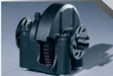
Mitteldifferential mit Stahlhauptzahnrad komplett gekapselt, verhindert Defekte durch Steine, groben Schmutz usw.
