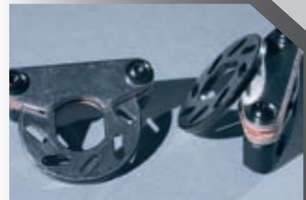
Extra dicke und belüftete Doppel-Bremsscheiben, getrennt einstellbar für vorne und hinten, verzögern den Mantis sicher und brutal.
