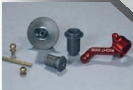
Harteloxierte Aluteile bei Dämpfer, Radachse und Diffausgängen, Titan-Nitrid-beschichtete Kugelköpfe und Kolbenstangen, alles vom Feinsten.
