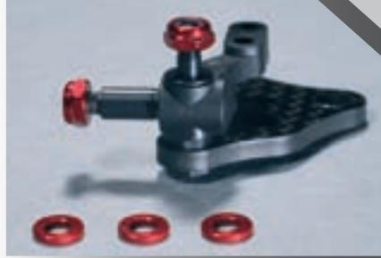
4-fach einstellbare Bodenfreiheit an der Vorderachse mittels Distanzringen für optimale Höheneinstellung.
