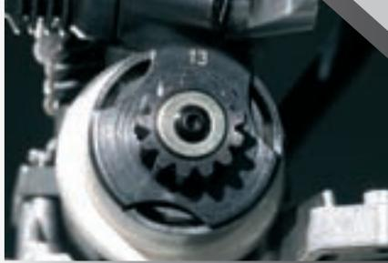
Belüftete Kupplungsglocke mit 13 Zähnen aus gehärteten Stahl für hohe Lebensdauer und fetzige Beschleunigung.
