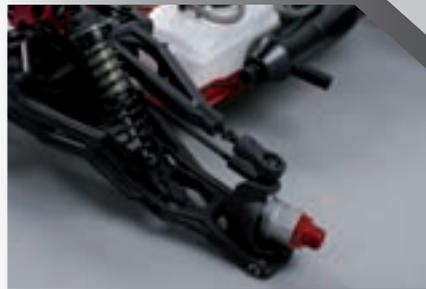
Lange Querlenker auf der Vorderachse und ...
