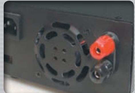
Die Rückansicht des Schaltnetzteils. Der Ventilator ist temperaturgeregelt und setzt nur bei hohen Belastungen ein. Anschlüsse sind für Bananenstecker vorgesehen.
