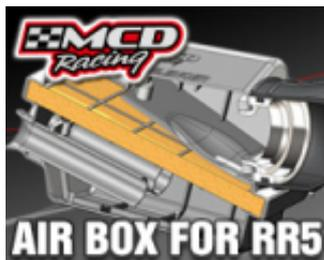
Die neue Air Box ist zu 100% kompatibel für alle Modelle der 5er Serie. Dank dieser Box kann die Geräuschentwicklung des Fahrzeuges bis zu 4dB reduziert werden.
