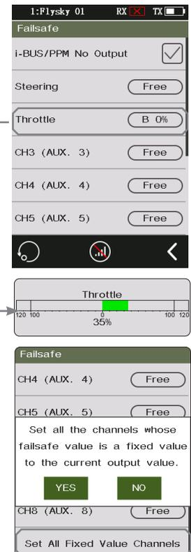
Sie können auch [Set All Fixed Value Channels] verwenden, um die Ausfallsicherheit für alle Kanäle gleichzeitig einzustellen. Diese Funktion kann nur für Kanäle eingestellt werden, bei denen Failsafe aktiviert ist. Hinweis: Gasbetriebene Modelle unterscheiden sich geringfügig in Bezug auf die ausfallsichere Einrichtung.
