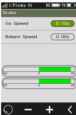
Fortschrittsbalken 1: zeigt die Ausgangsgeschwindigkeit des Kanals nach der Verzögerung (s. links).
