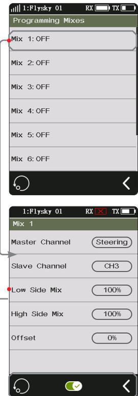
Weisen Sie VR-, TR-Tasten o.ä. in der Funktion [Key Setting] zu, um 8 Mischsteuerungsgruppen [Low End Mixing], [High End Mixing] und [Offset] einzustellen. Durch Drücken der Taste erscheint bei der Justierung ein Popup-Fenster, das den Echtzeitwert abfragt. Darüber hinaus ist es möglich, die Funktionen von Mix 1 bis Mix 8 mit der SW-Taste schnell zu aktivieren oder zu deaktivieren.
