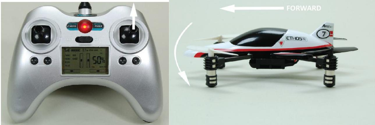
Ziehen Sie den Knüppel zurück, so wird die Nase angehoben und Ihr Quadcopter fliegt rückwärts.
