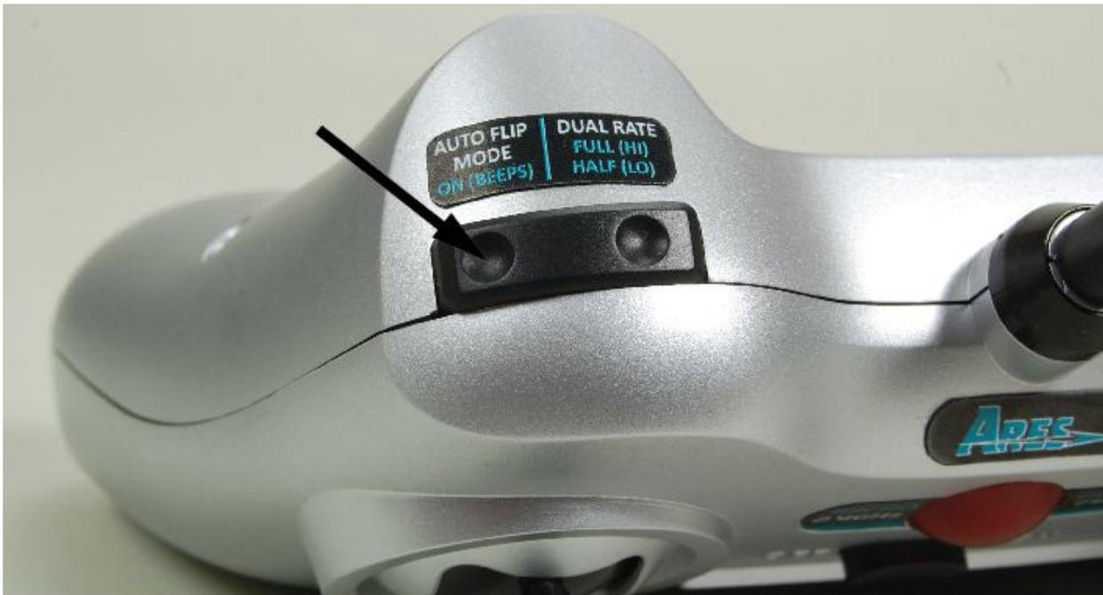
Durch Drücken der „AUTO FLIP MODE“ Taste wird der Automatic Flip Modus (AFM) aktiviert. Die Taste befindet sich links oben auf der Stirnseite der Fernsteuerung. Bei Betätigung ertönen kontinuierlich Signaltöne. Gleichzeitig leuchtet am Quadcopter die rote LED anstelle der grünen LED auf.
