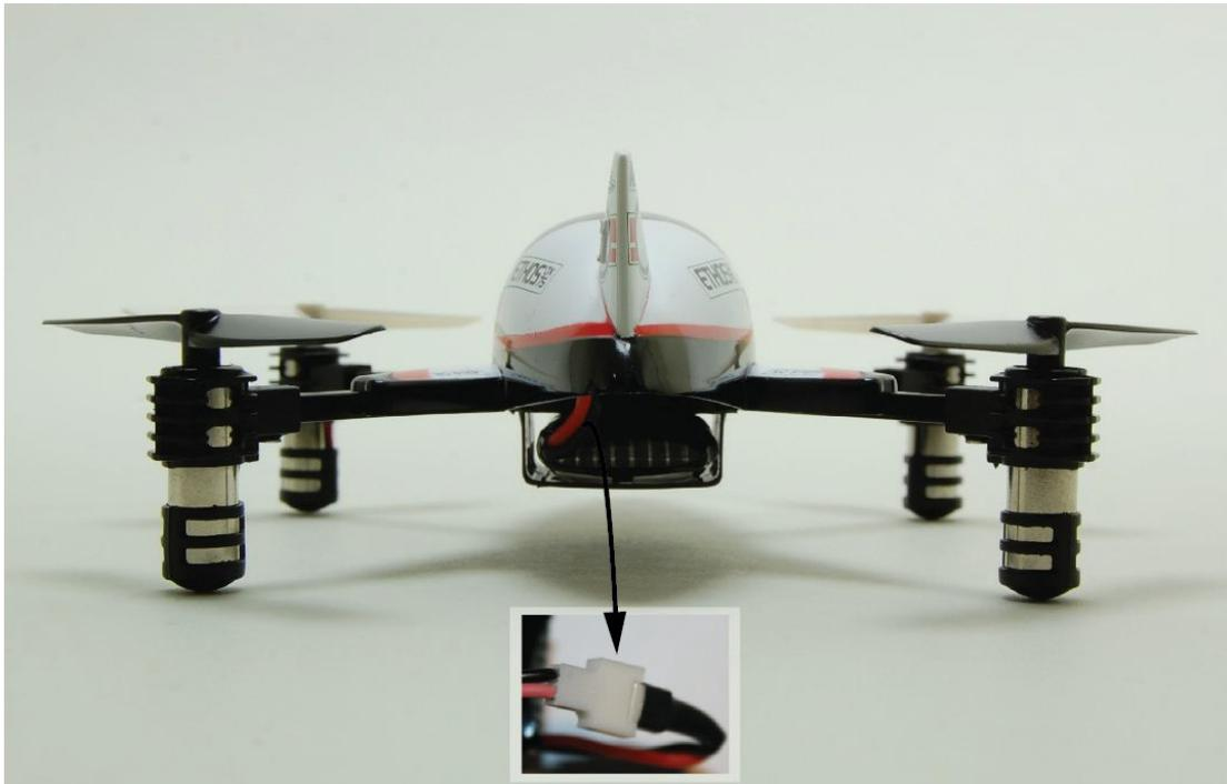
Achten Sie darauf, dass das Akkukabel nicht in die Nähe der Rotorblätter gelangt, Sie können es unter die Verkleidung stecken.
