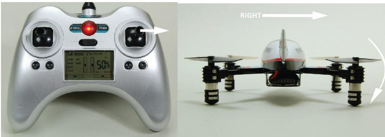
Die Trimmung des Querruders kann dazu verwendet werden, den Seitendrift des Ethos QX 75 zu minimieren. Wenn der Quadcopter ohne Steuerbewegung nach rechts gleitet, trimmen Sie das Querruder so lange nach links, bis Ihr QX 75 ruhig schwebt.
