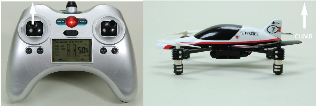
Wenn Sie den Knüppel wieder nach unten bewegen, wird die Rotordrehzahl reduziert und der Quadcopter sinkt ab.
