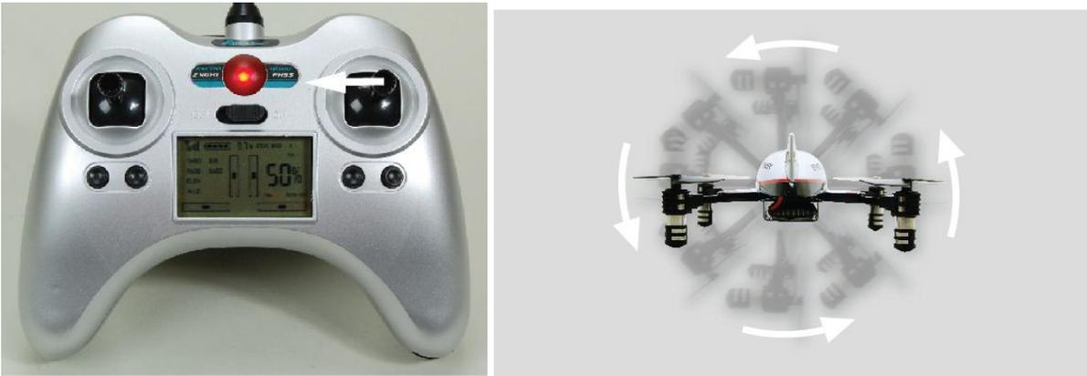
Bewegen Sie das Querruder nach rechts, so vollführt der Quadcopter eine Rolle nach rechts.
