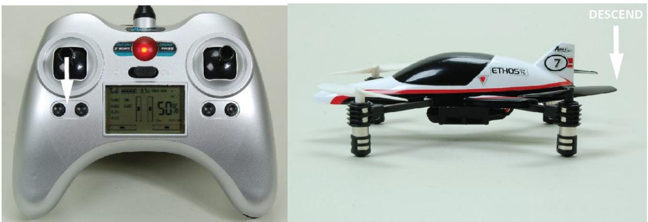
Nach dem Start können Sie Ihren Ethos QX 75 schweben lassen, indem Sie den Gasknüppel vorsichtig hoch und runter bewegen, bis der Quadcopter die Höhe hält. Bewegen Sie den linken Knüppel nach links, dreht der QX 75 nach links. Dies wird durch Erhöhung der Drehzahl am rechten vorderen und linken hinteren Propeller erzielt.
