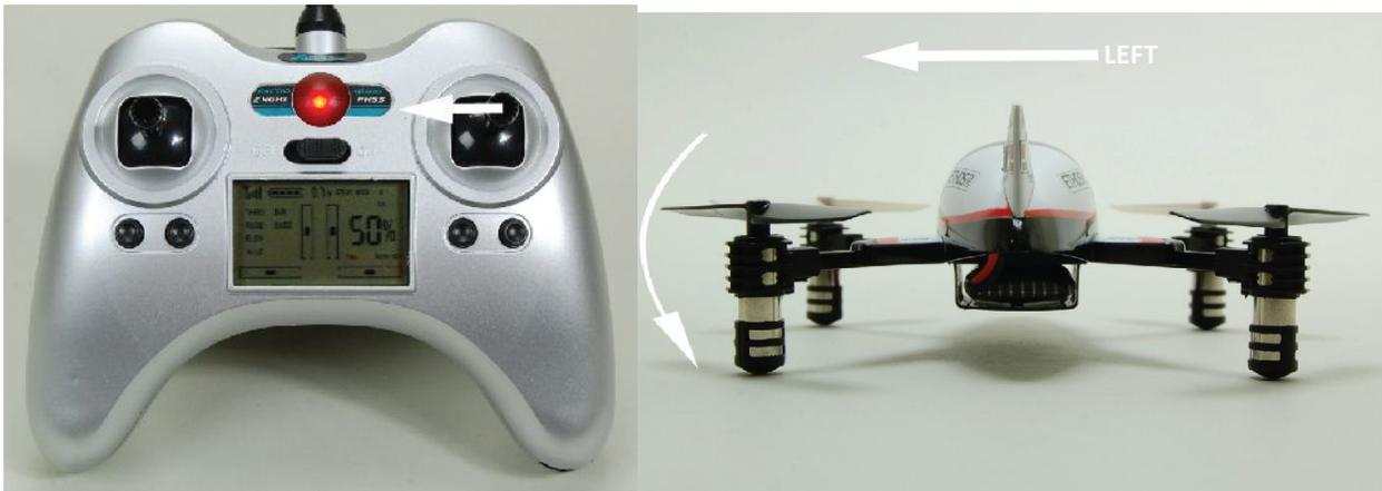
Ziehen Sie den Knüppel nach rechts, neigt sich der Quadcopter nach rechts, sodass er nach rechts fliegen kann.
