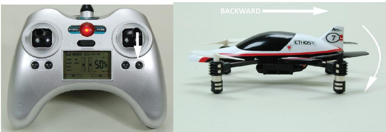
Die Höhenrudertrimmung kann dazu verwendet werden, den Drift beim Schweben zu minimieren. Wenn der Ethos QX 75 beim Schweben vorwärts driftet, verstellen Sie die Trimmung nach hinten, bis der Quadcopter ruhig an der Stelle schwebt.
