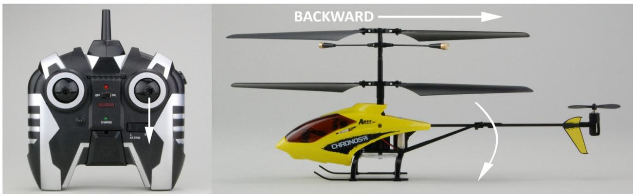
Lenken Sie den Knüppel nach links oder rechts, so dreht sich die Nase zur Lenkbewegung. Dies wird erreicht, indem die Drehzahlen der Hauptrotoren unterschiedlich stark variiert werden. Die Nase schwenkt nach links, wenn der obere Rotor schneller dreht als der untere.
