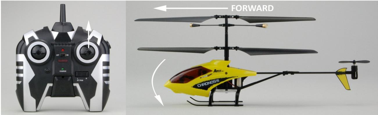
Ziehen Sie den Knüppel zurück, so hebt der Helikopter die Nase und kann rückwärts fliegen.
