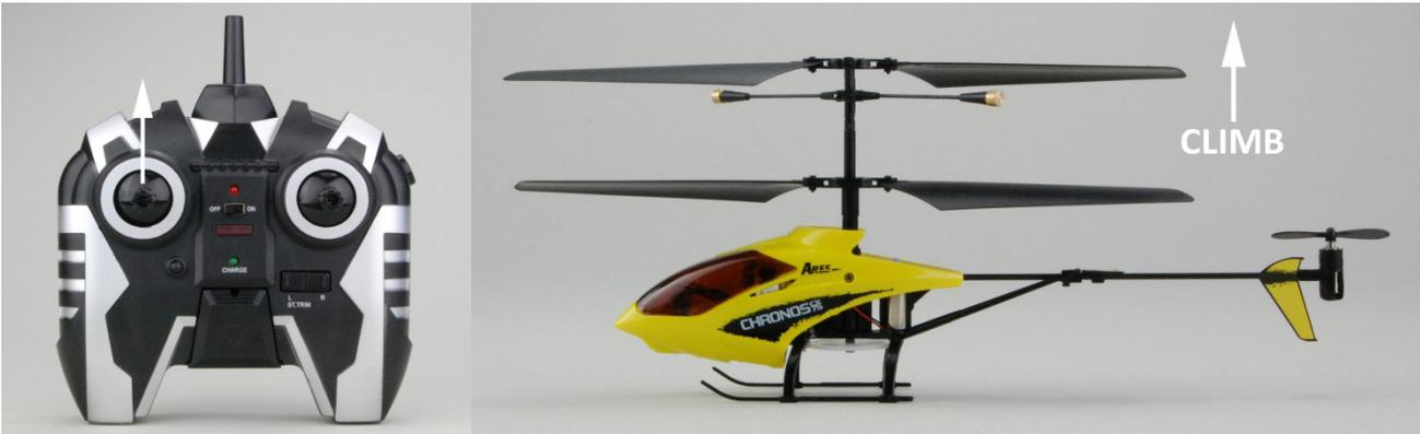
Wenn Sie den Knüppel wieder nach unten bewegen, wird die Rotordrehzahl reduziert und der Helikopter sinkt ab.
